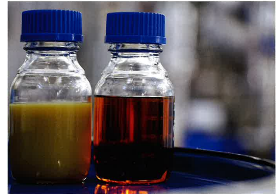
Mittels Pyrolyse wurde Öl aus Kunststoffabfällen zurückgewonnen. Bild: NGE
